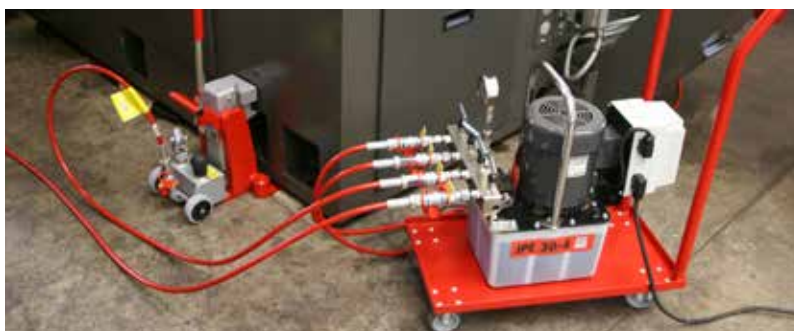
Elektropumpe JPE 30 NVR mit 2 Hebeegeräten im Einsatz
