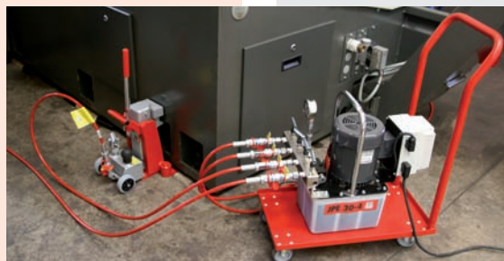
Elettropompa JPE 30 NVR con 2 binde in uso
