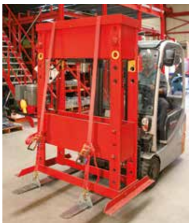
Rakomány biztosítás villaszorítókkal és hevederekkel
