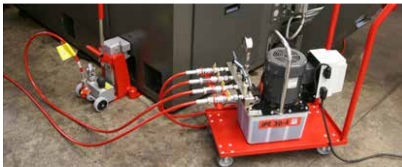
JPE 30 NVR elektromos szivattyú 2 emelővel használva.
